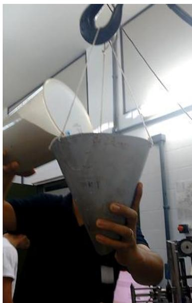
**Figura 6.12. Funil para despejo de areia na centrífuga de viga.**
