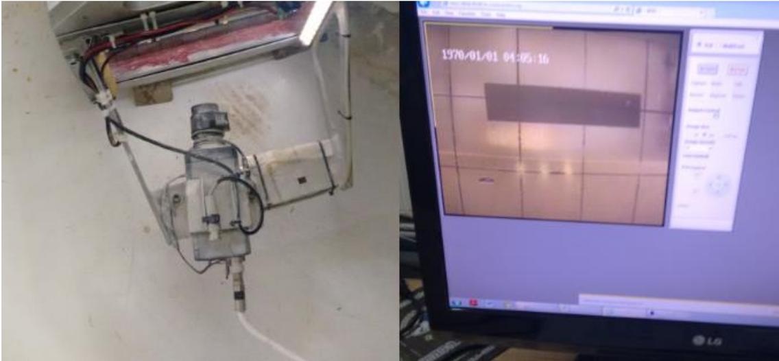
Figura 6.8. Câmera para monitoramento do ensaio na centrífuga de viga.
