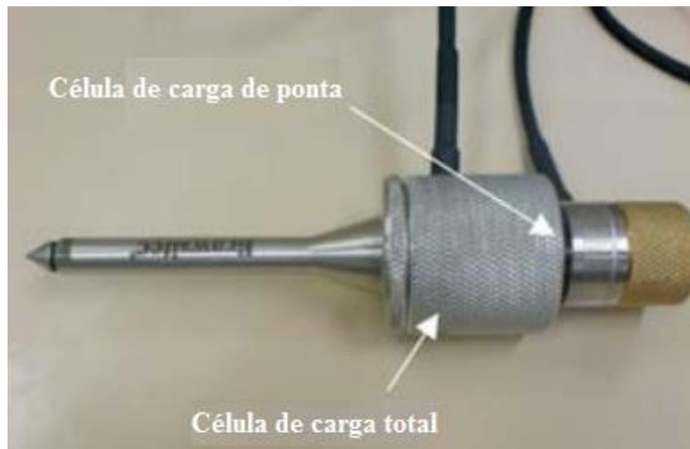
**Figura 7.7. Visão geral do mini-CPT (ALMEIDA, OLIVEIRA, *et al.*, 2011).**
