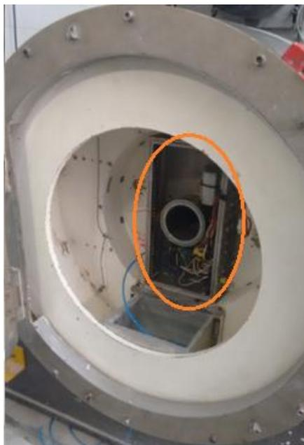
**Figura 6.10.** Sistema de aquisição de dados e instrumentação (local da mesa central) da centrífuga de tambor.
