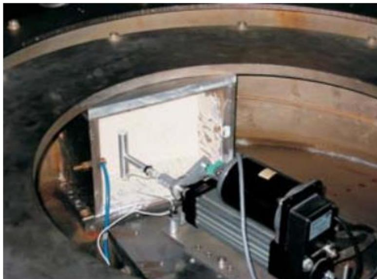
**Figura 7.6 Barra-T em posição para penetração (ALMEIDA, OLIVEIRA, *et al.*, 2011).**
