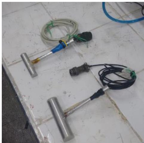
**Figura 6.5 Barra T para caracterização de solo mole em centrífugas de tambor.**
