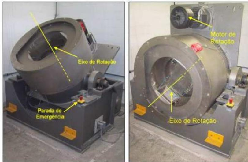
Figura 3.8. Posições do eixo de rotação (OLIVEIRA, 2005).
