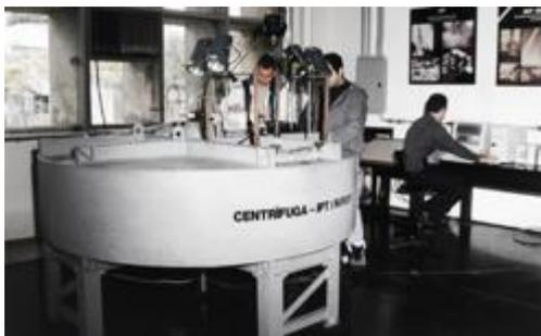
**Figura 3.11. Centrífuga para ensaio de modelos reduzidos IPT (IPT, 2015).**
