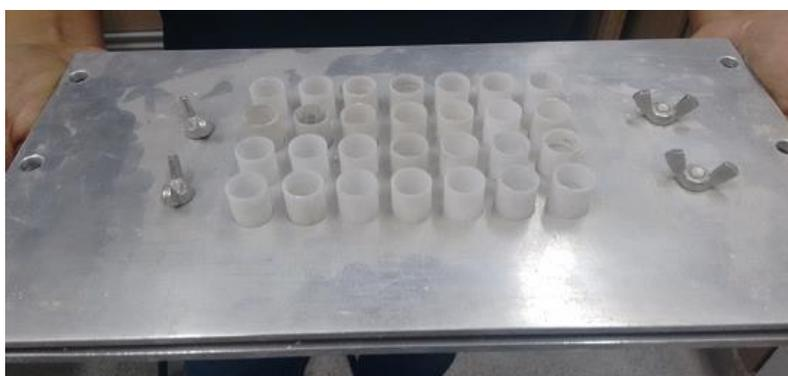
**Figura 6.6 Placa para execução de grupo de estacas em centrífuga de tambor.**
