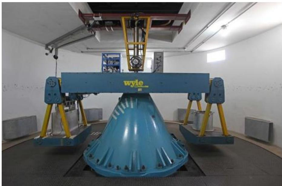
**Figura 3.10** Centrífuga da UENF (KOPSCITZ, 2013).
