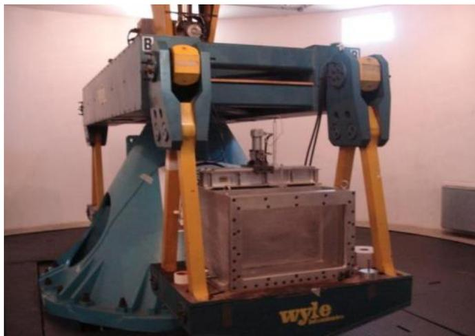
**Figura 5.1.** Vista da plataforma da centrífuga de viga da UENF com a caixa teste com janela de visualização (SANTIAGO, ALBUQUERQUE, *et al.*, 2010).
