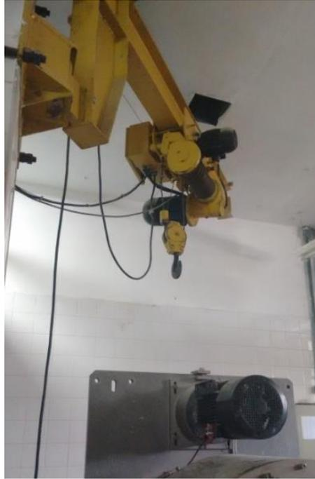
**Figura 6.1.** Talha elétrica para auxílio no transporte de equipamentos.
