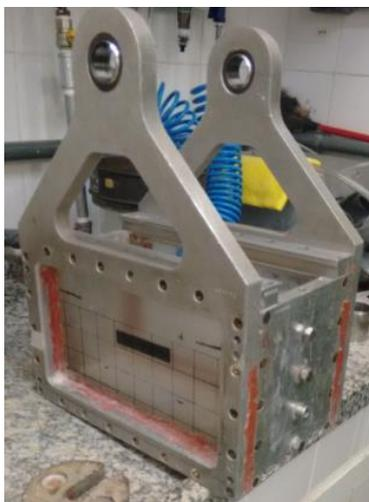
**Figura 6.11.** Caixa da centrífuga de braço.
