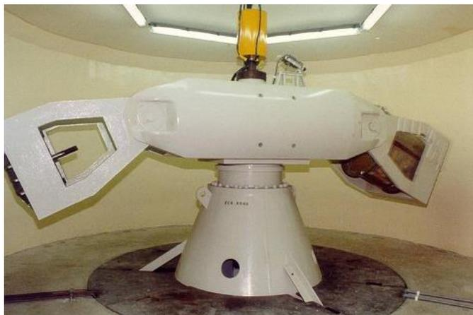
**Figura 3.2. Centrifuga de viga simétrica (NUS, 2015).**
