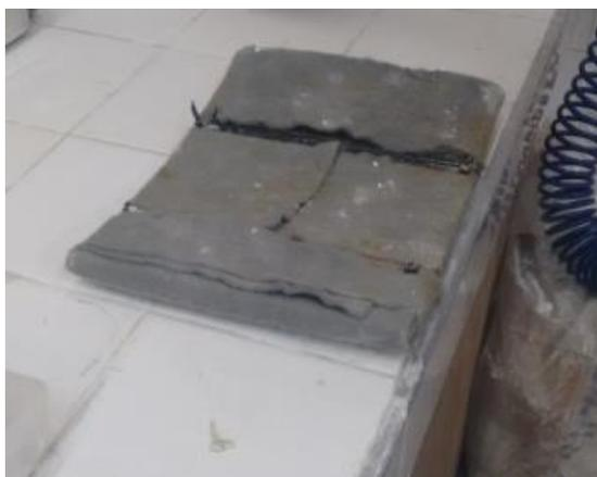
**Figura 6.4 Placa coberta com geotêxtil não tecido para aplicação de tensões em áreas e adensamento na centrífuga de tambor.**
