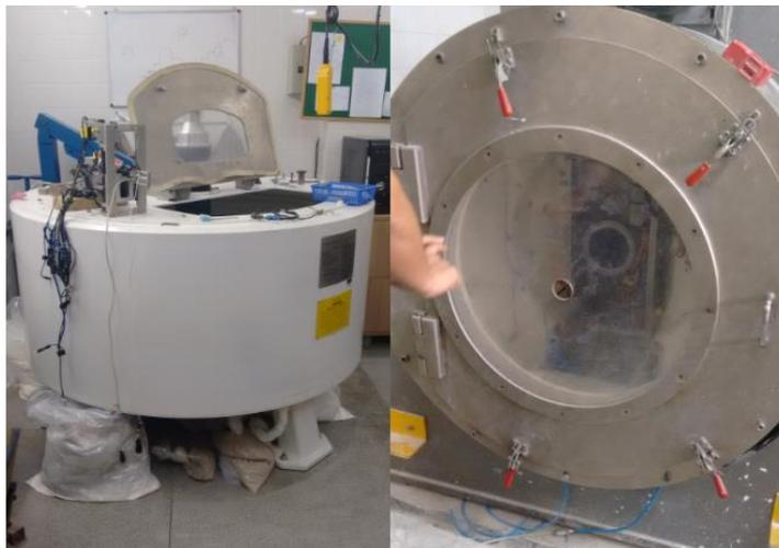
**Figura 6.2** Centrífuga de viga de tambor da COPPE/UFRJ.
