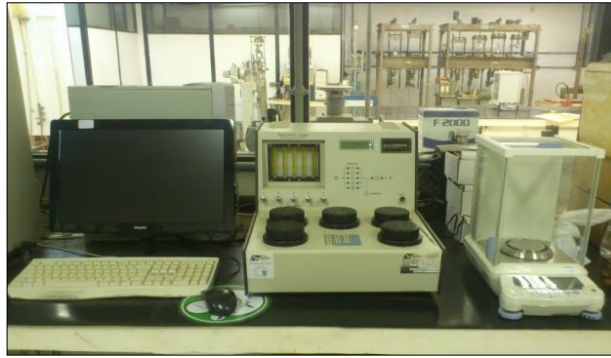
Figura 4.4. Pentapicnômetro Modelo PENTAPYC 5200E (METOGO, 2013)
