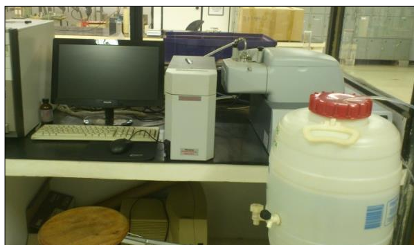
Figura 4.3. Granulômetro a laser. Marca MICROTRAC Modelo S3500 (METOGO, 2013)
