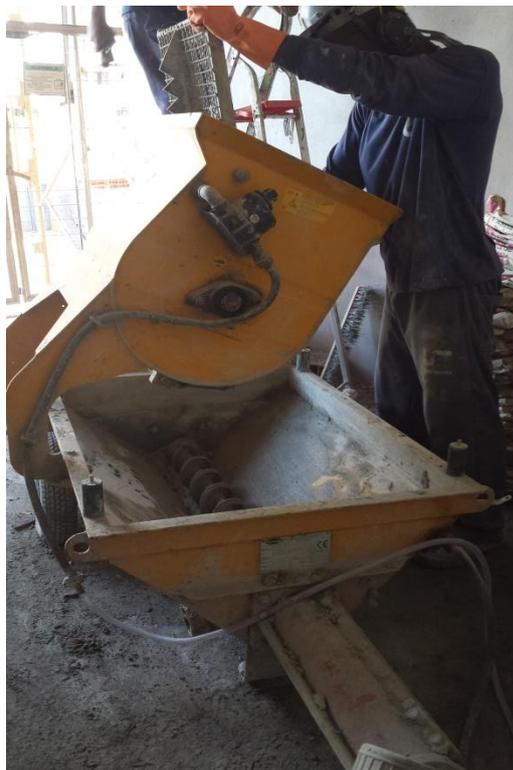
Figura 29 – Operador de máquina realizando a montagem e os ajustes iniciais na bomba de projeção antes de iniciar o procedimento de projeção da argamassa.
