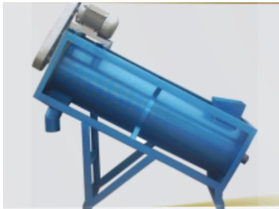
Figura 13 - Secadora oblíqua da marca Gold Press.
