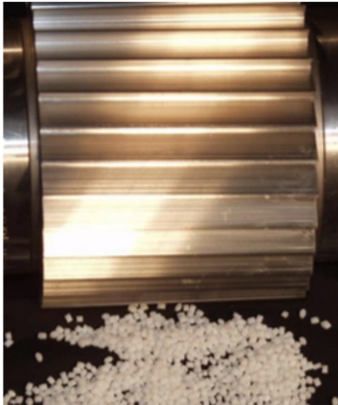
Figura 19 - Rotor com 30 dentes para a produção de pellets.
