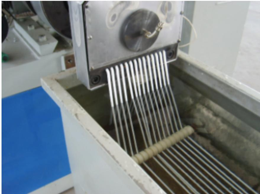
Figura 16 - resfriamento do "espaguete" produzido na extrusora.
