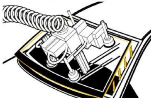
Figura 2.6 - Aplicação do adesivo no para-brisas e aplicação robotizada do mesmo. (Maia, 2010).
