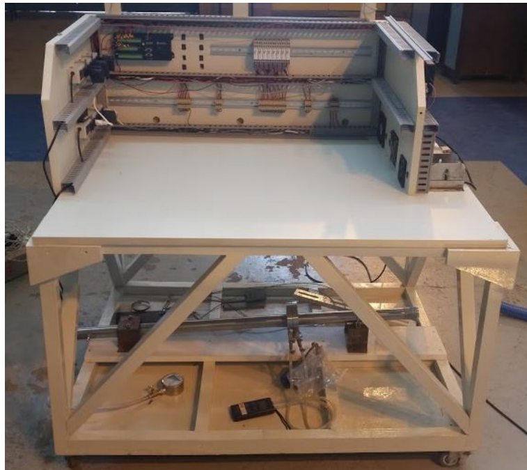
Figura 5.1: Bancada usada para receber os dados enviados pelos sensores presentes no concentrador solar.
