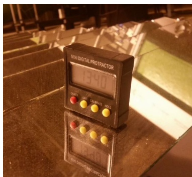
(a) Inclinômetro usado para calibrar os espelhos.
