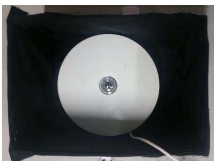
(b) Piranômetro posicionado dentro da caixa na ausência do vidro.
