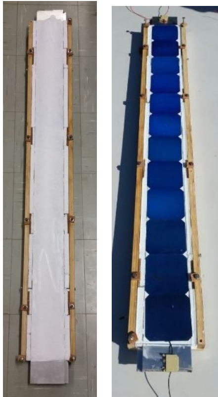
(a) Preenchimento de pasta térmica na superfície do duto de alumínio. (b) Posicionamento da célula fotovoltaica no coletor solar.
