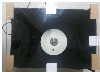
(c) Piranômetro posicionado dentro da caixa na presença do vidro.
