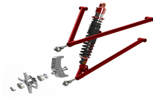
Figura 2.13: Vista explodida de suspensão Duplo-A. Equipe de Baja SAE Piratas do Cerrado.
