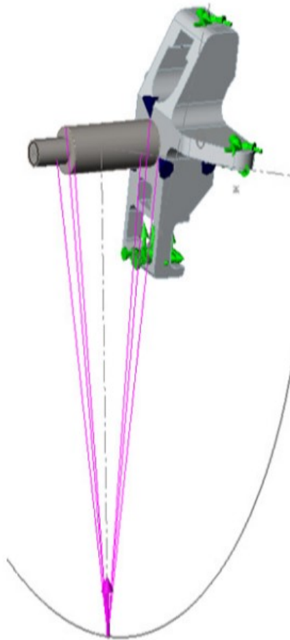
Figura 4.4: Condições de contorno e forças aplicadas por Yan (2011).
