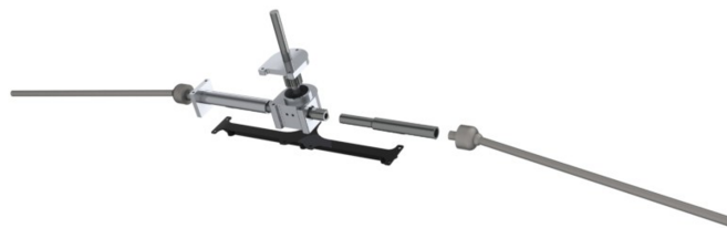
Figura 2.15: Sistema de direção de pinhão e cremalheira. Equipe de Baja SAE Piratas do Cerrado.
