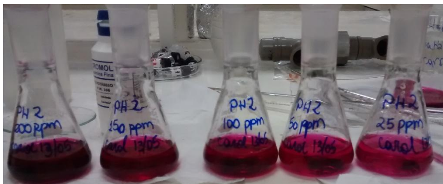
Figura 12 - Soluções aquosas com diferentes concentrações de fucsina ácida para pH igual a 2.
