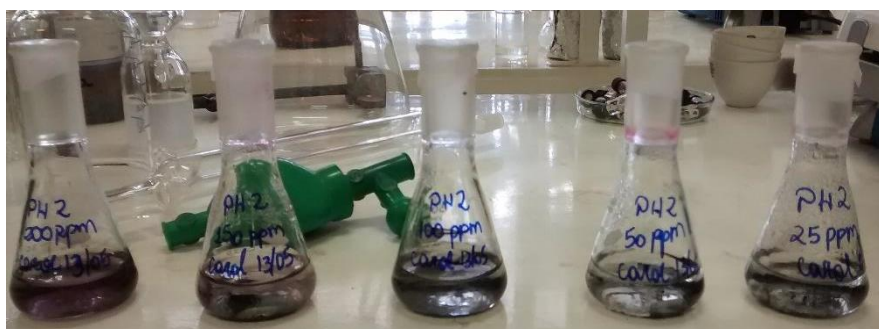
Figura 13 - Soluções aquosas em pH 2 com diferentes concentrações de fucsina ácida após tratamento com carvão ativado.
