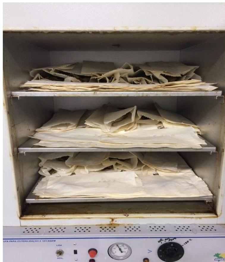
Figura 3: Estufa de ventilação forçada, onde se realizou o processo de secagem –  $70\text{ }^{\circ}\text{C} \pm 2\text{ }^{\circ}\text{C}$  –, por 24 horas. Brasília-DF, 2016. Fonte: OLIVEIRA, 2016.
