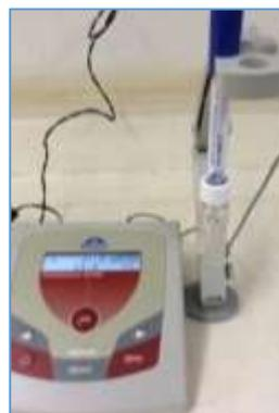
Figura 6: Aparelho de leitura de condutividade elétrica. Foto: Souza, 2016.
