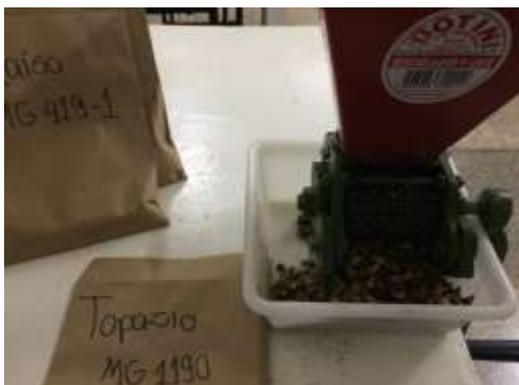
Figura 3: Máquina descascadora de café. Foto: Souza, 2016.
