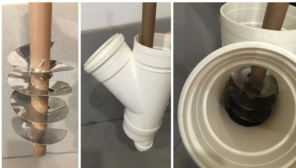
Figura 51 – Bico extrusor construído pela equipe da InovaHouse3D (Fonte: autora)
