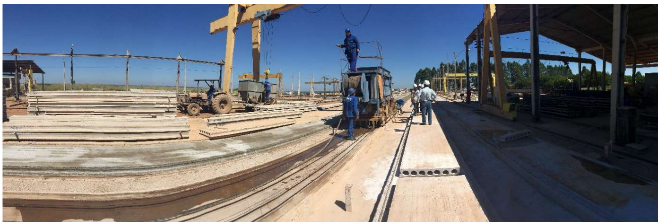
Figura 58 – Produção de lajes alveolares na TECRON (Fonte: autora)
