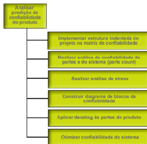
Figura 3.16. Etapas para Analisar Predição de Confiabilidade do Produto (Fonte: BARBALHO, op. cit. , p. 161 – Apêndice A)
