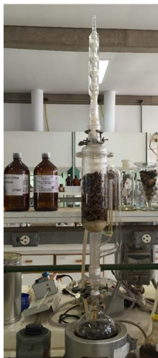
Figura 9. Obtenção do LCC natural cascas das castanha de caju. (a) Extração em sistema Soxhlet, (b) Concentração do extrato em evaporador rotatório.
