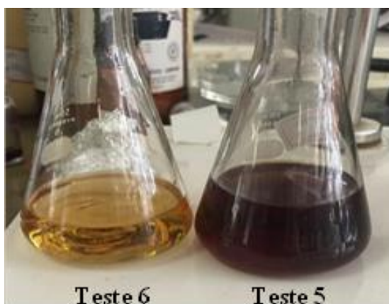
Figura 19. Aspecto dos produtos de descarboxilação do LCC, obtidos nos Testes 6 e 5, respectivamente com e sem solvente.
