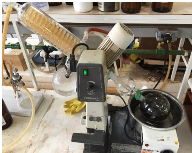
Figura 9. Obtenção do LCC natural cascas das castanha de caju. (a) Extração em sistema Soxhlet, (b) Concentração do extrato em evaporador rotatório.
