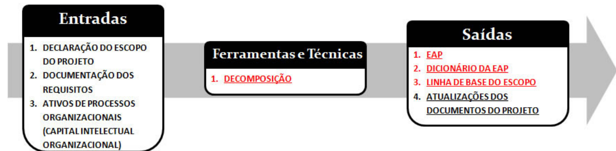
Figura 3-8. Criar a estrutura analítica do projeto (EAP): entradas, ferramentas e técnicas e saídas
