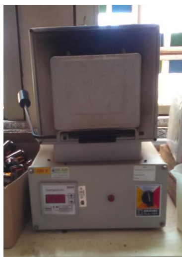
Figura 6 - Mufla da EDG Equipamentos utilizada para a pirólise.
