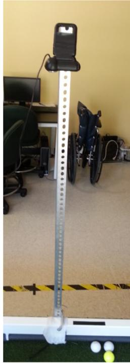
Figura 3.3: Câmera secundária fixada ao suporte ligado à plataforma
