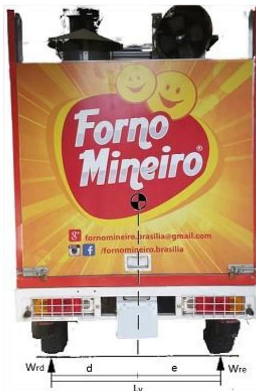
Figura 7.2 - Cargas estáticas no plano transversal
