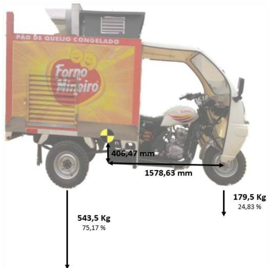
Figura 7.10 - Esquemático Lateral PBT (Cheio).
