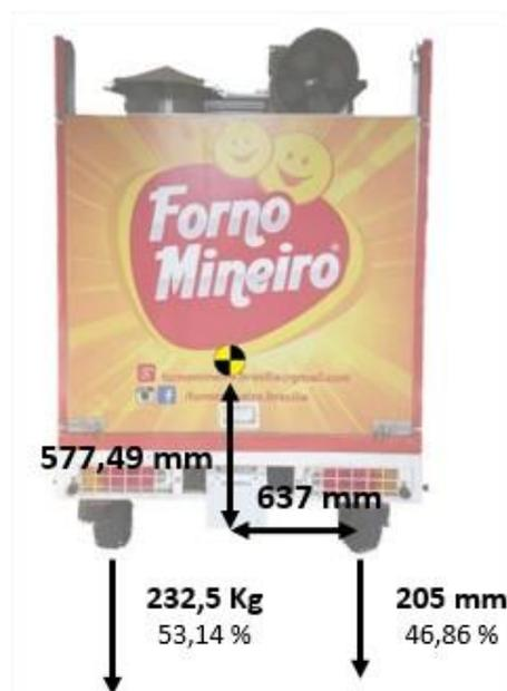
Figura 7.11 - Esquemático traseiro EOM.
