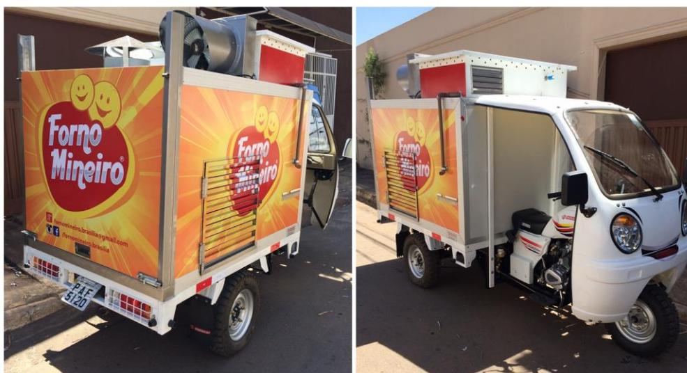
Figura 2.3 - Triciclos com sistema atual de refrigeração
