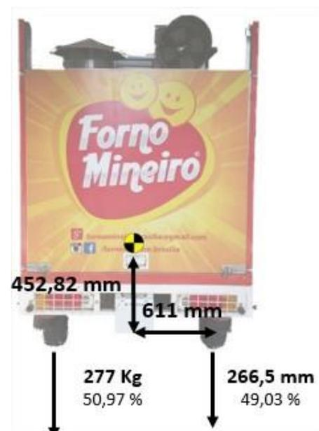
Figura 7.12 - Esquemático traseiro PBT (Piloto).
