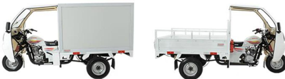
Figura 2.2 – Modelos de triciclo com compartimentos de carga aberto e fechado (MOTOCAR, 2009).
