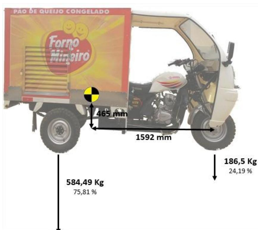
Figura 7.15 - Esquemático lateral para o triciclo proposto.
