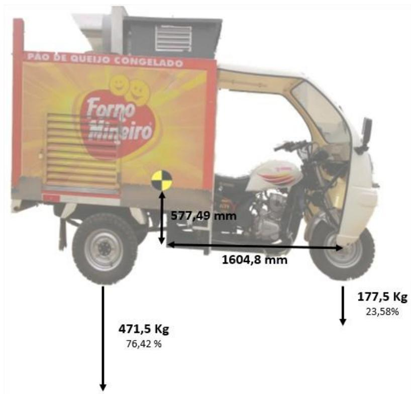
Figura 7.8 - Esquemático lateral EOM.
