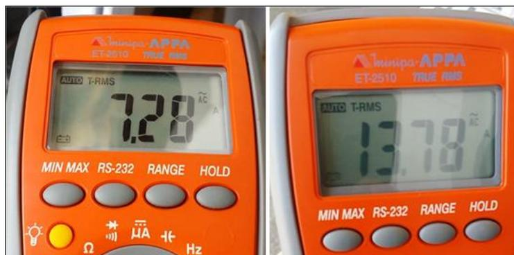
Figura 5.10 - Medições realizadas da corrente de partida do refrigerador com Multímetro Digital ET-2510 Minipa - ET-2510 - Interface RS-232.
