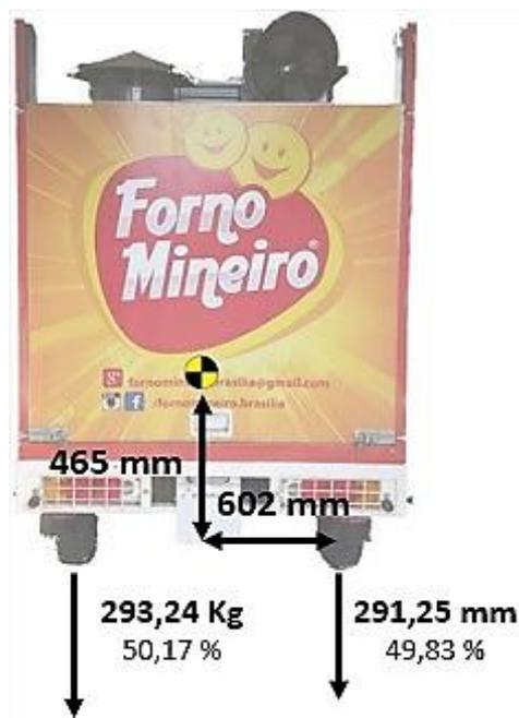
Figura 7.16 - Esquemático traseiro para o triciclo proposto.
