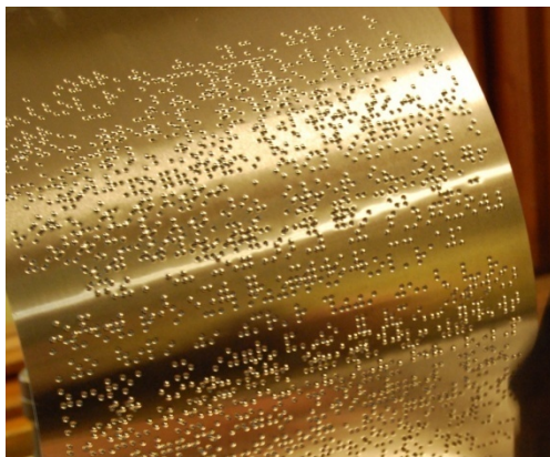
Figura 83 –Clichê de metal para impressão em braille
