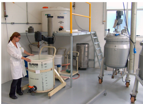
Figura 14 – Agitadores mecânicos em uso na indústria química
