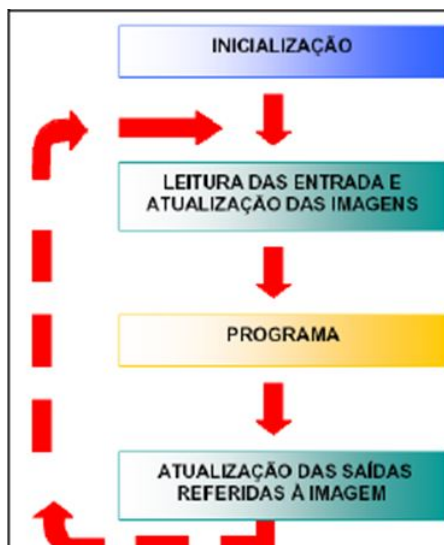
Figura 18 – Ciclo de processamento de um CLP
