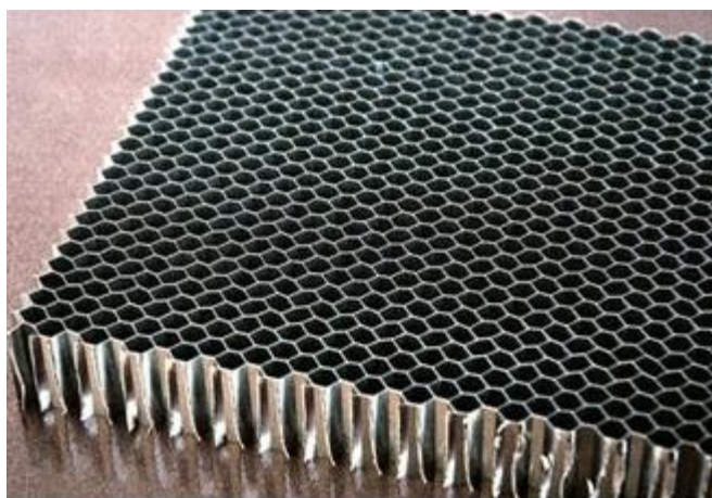
Figura 18: Estrutura hexagonal de Honeycomb [ALUSTRONG, 2016]
