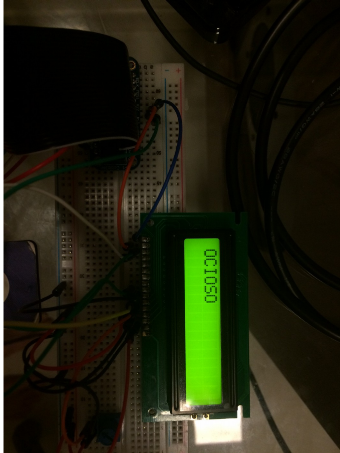
Figura 47: Display exibe o estado "OCIOSO" quando não há gravação de vídeo.
