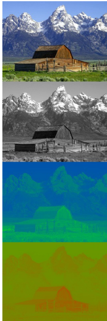
Figura 14: Componentes Y, U, e V da imagem original [10].
