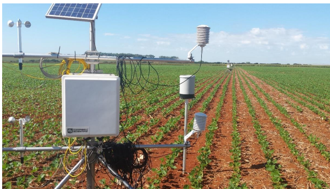
Figura 4. Estação automática do sistema razão de Bowen no interior de um pivô central localizado na Bacia do Ribeirão Buriti Vermelho, Distrito Federal, ao final do primeiro mês do ciclo da cultura do feijão, em Maio de 2015.
