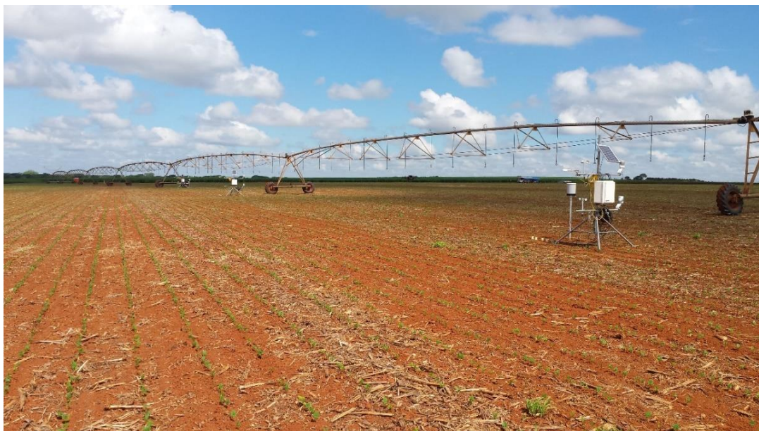
Figura 3. Posicionamento das estações do sistema razão de Bowen no interior do pivô localizado na Bacia do Ribeirão Buriti Vermelho, Distrito Federal, em Maio de 2015.
