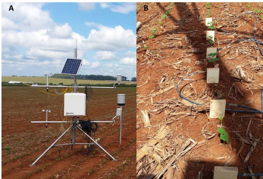
Figura 2. Estação meteorológica do sistema razão de Bowen e seus respectivos sensores no interior do pivô, uma semana após o plantio da cultura do feijão, em Maio de 2015 (A). Disposição dos sensores TDR entre plantas na linha de plantio (B).
