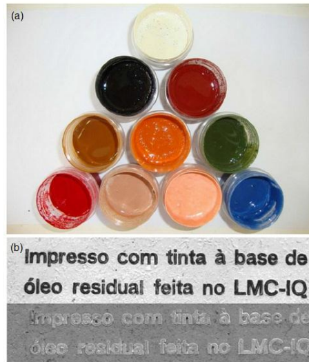
Figura 12 - (a) Tintas confeccionadas a partir da mistura de diferentes pigmentos com resinas poliméricas de óleo de fritura usado; (b) teste de impressão com tintas de óleo de fritura. Fonte: adaptado de MONTENEGRO et al. , 2013; MELLO, OLIVEIRA e SUAREZ, 2013.
