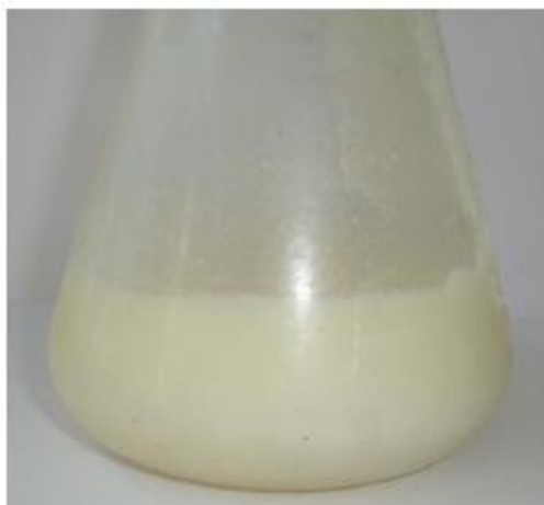
Figura 10 - Resina polimérica obtida a partir dos óleos residuais de fritura. Fonte: MONTENEGRO et al. , 2013.
