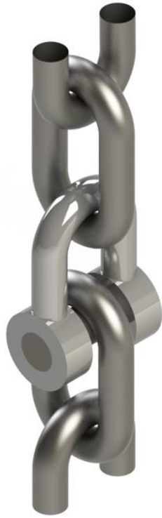
Figura 4.1 Dois elos de corrente em contato. Fonte: [33].
