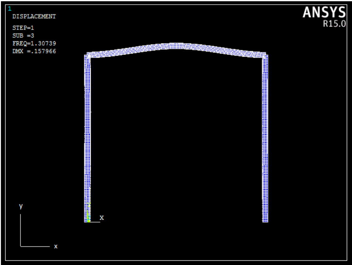
Figura 25 - Representação deformada para o terceiro modo
