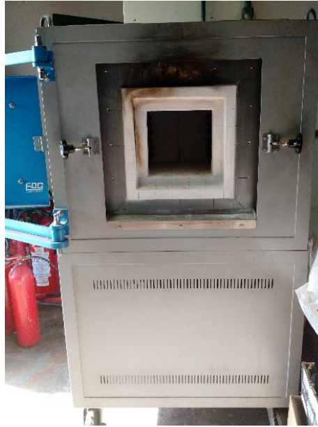
Figura 4: Mufla da EDG Equipamentos utilizada para a pirólise.
