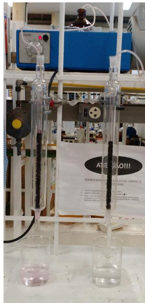
Figura 5: Esquema de colunas de adsorção com carvão ativado e carvão ativado com biofilme.
