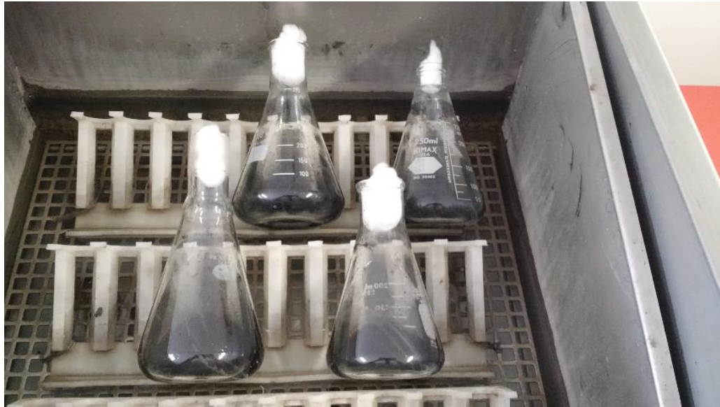
Figura 7: Reatores biológicos em um misturador com banho térmico a 30°C.
