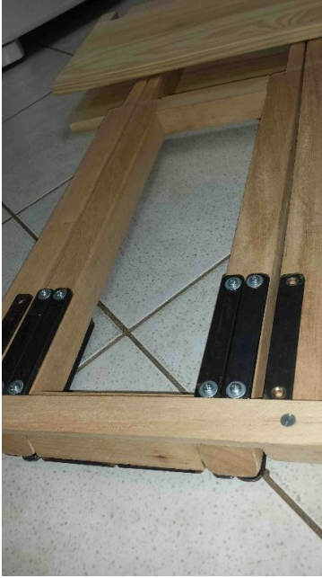
Imagem 32 - Produto - metais utilizados para abaixamento do centro de massa.
