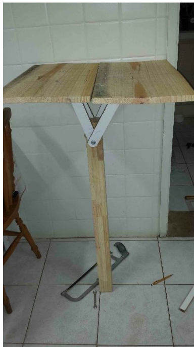
Imagem 22 - protótipo de mesa de perna centralizada.
