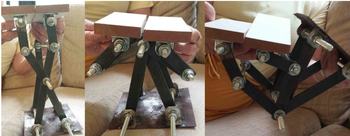
Imagem 23 - sequência explicativa do sistema retrátil do protótipo de perna centralizada.
