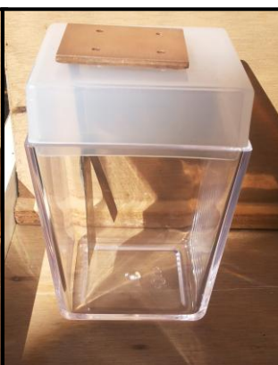
Figura 6: Experimento Efeito Fotoelétrico sendo realizado com o quarto protótipo e com a plaquinha de cobre.
