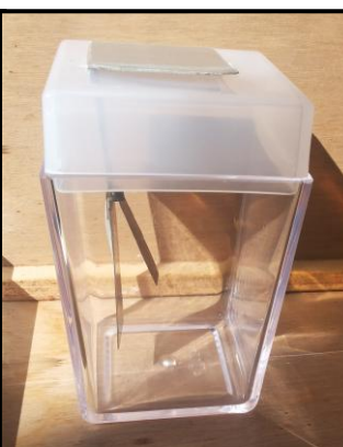
Figura 5: Experimento Efeito Fotoelétrico sendo realizado com o quarto protótipo e com a plaquinha de alumínio.
