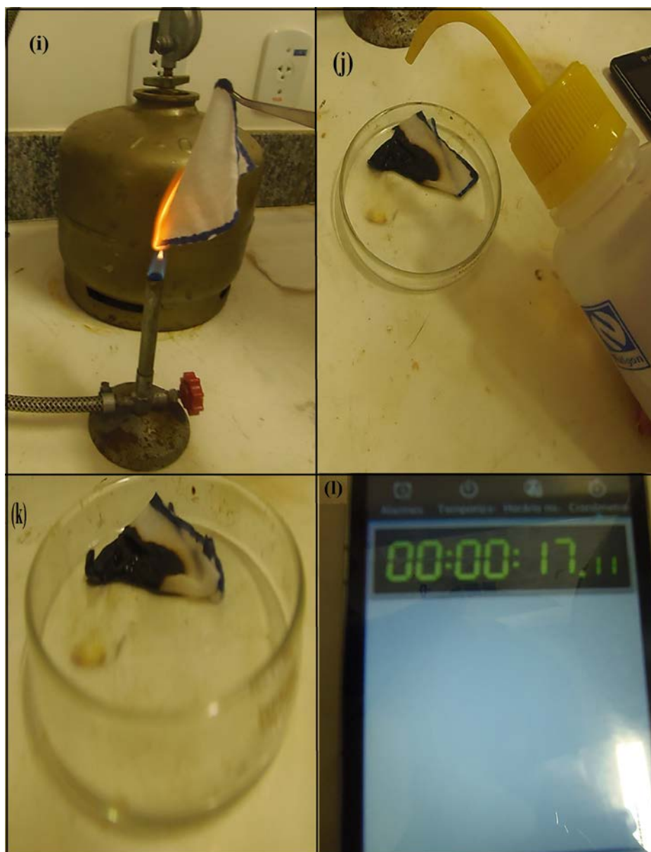
Imagem parte 3. Retirada do fogo. (Resfriamento) . (i) Segunda fita de tecido, em combustão. (j) Segunda fita de pano, na placa de Petri, e em contato com a água. (k) Tira de tecido em contato com a água. (l) Tempo que levou para que a chama apagasse.
