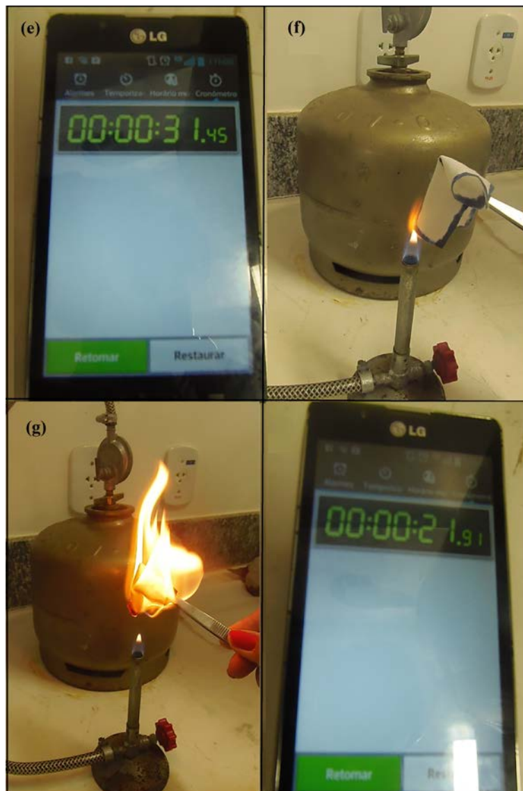
Imagem parte 1. Retirada do combustível. (e) Tempo que levou para que a chama apagasse da primeira tira. (f) Segunda tira de pano, em contato com a chama.(g) Tira de tecido, completamente em chamas, ela que foi retirada do contato com o fogo, 10 segundos a menos, em relação a primeira tira.(h) Tempo que levou para que a chama apagasse da segunda tira
