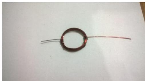
Com um pedaço de lixa ou com um estilete raspe totalmente apenas uma das extremidades da bobina e a outra extremidade raspe-a parcialmente.
