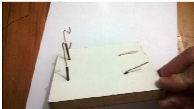
Agora com um pedaço de cano em PVC pegue um pedaço de fio de cobre esmaltado e o enrole formando um anel de bobina com 10 voltas. Logo em seguida retire a bobina e enrole cada extremidade do fio a sua parte interna formando um ângulo de 180° entre as partes enlaçadas conforme figuras.
