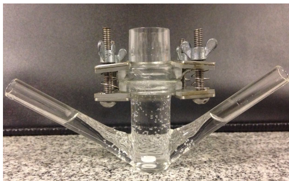
Figura 9. Representação da célula de difusão de Franz para o experimento in vitro de liberação.
