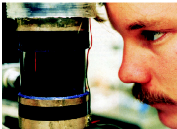
Figura 1.7: Ressonador acústico com dois transdutores separados por um cilindro de vidro. Ondas estacionárias de 20 kHz a 100 kHz e campos de pressão de até 3 bars são gerados no líquido. Se a pressão acústica for grande o suficiente, várias bolhas serão geradas. Se a pressão não for tão alta, é possível uma “levitação acústica” de uma bolha de gás, que pode gerar luz a cada ciclo acústico. Na foto, Sean Cordry observa a sonoluminescência azul. - Fonte: L. A. Crum/Sonoluminescence.
