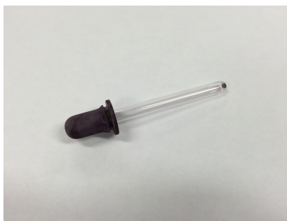
Figura 4.46: Conta-gotas utilizado na deposição de Solução Semicondutora
