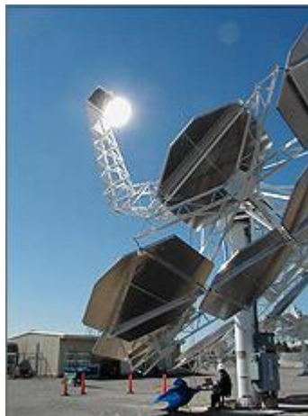
Figura 2. Sistema CPS com Motor Stirling (NREL, 2014)
