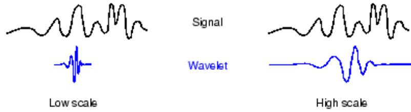
Figura 2.8: Para escalas pequenas (esquerda), a base é comprimida e permite analisar detalhes. Para escalas maiores (direita), a base é expandida e permite analisar variações lentas no sinal. [4]
