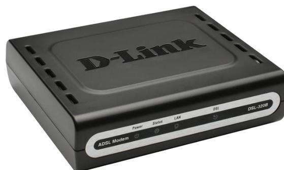
Figura 1.2 Exemplo de *modem* DSL. [3]
