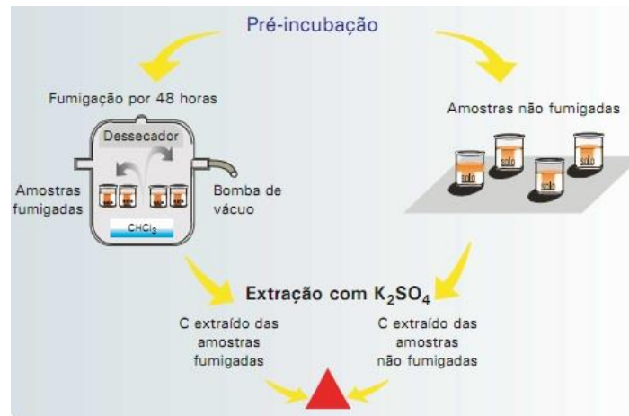
Figura. 3. Esquema da determinação do carbono da biomassa microbiana pelo método CFE.
