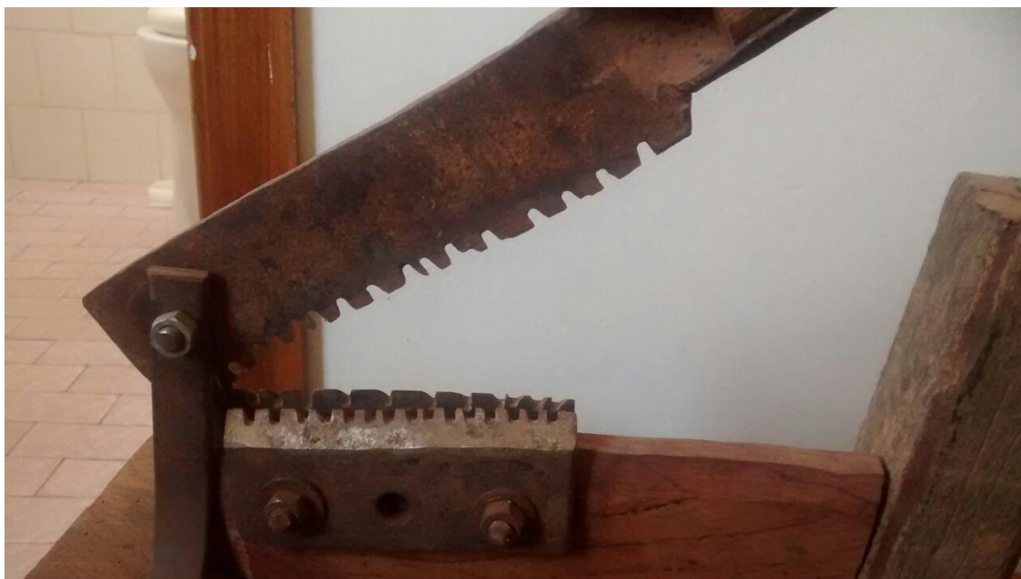
Figura 3 - Detalhe da ferramenta quebrador de castanha de Barú usado para extração das sementes de Caesalpinia ferrea Mart. (Fonte: Rosa, A.P.F., 2015).
