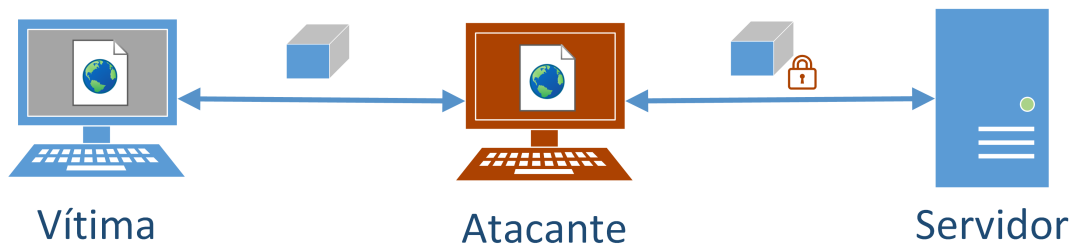
Figura 4.10: Esquema básico do SSL Stripping
