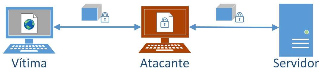
Figura 4.9: Esquema mostrando o atacante realizando o relay dos dados, porém não conseguindo visualizar as telas da vítima, por estas estarem cifradas
