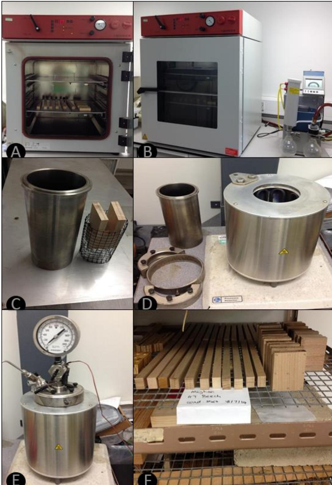
**Figura 3:** A: Forno à vácuo com as amostras sendo colocadas. B: forno à vácuo com o controlador de pressão interna ao lado. C: Cesta a ser colocada no dentro do cilindro para impedir o contato direto das amostras com a água. D: Reator desmontado com a peça de aquecimento, o cilindro que recebe as amostras e as peças de encaixe. E: Reator montado. F: sala de climatização.
