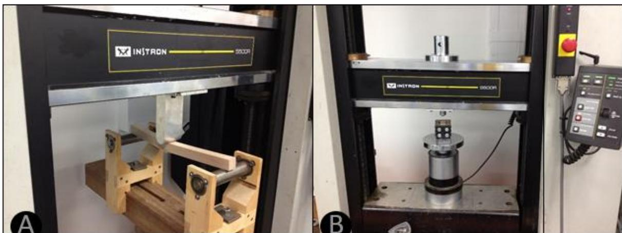
**Figura 4:** A: Máquina Instron em execução de teste de flexão estática. B: Máquina Instron em execução de teste de dureza Janka.
