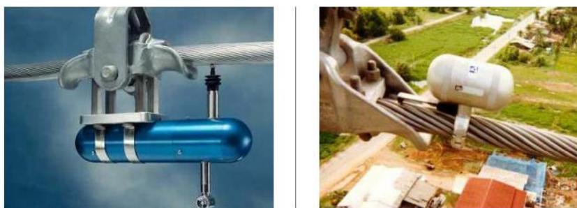
Figura 1.3 – Dois tipos de vibrógrafos instalados em linhas de transmissão (modificado: CLOUTIER & LEBLOND, 2011).
