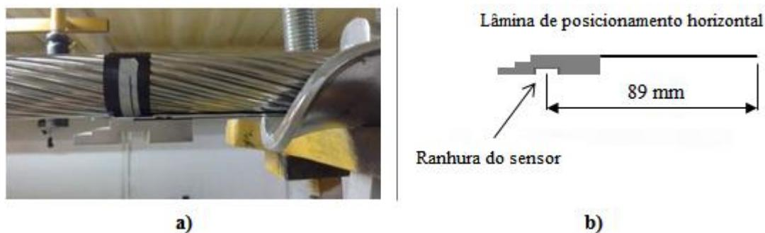
Figura 5.23 – Localização do Ponto 89: a) Posição do Ponto 89 marcada de caneta com uma linha; b) Ilustração do dispositivo de posicionamento do equipamento.
