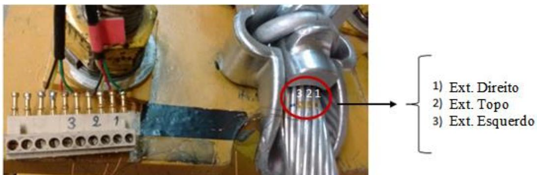
Figura 5.18 – Extensômetros colados nos fios de topo do cabo condutor no ensaio com o Pavica.
