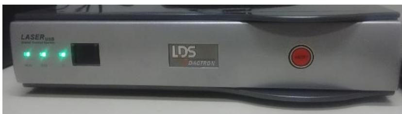
Figura 5.9 – Controlador LDS LASER USB da empresa Brüel & Kjaer.
