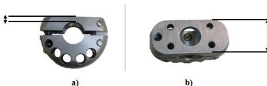
Figura 5.16 – Dimensões da braçadeira original preservadas para garantir: a) O permanente contato do sensor com o cabo; b) Referência na localização do Ponto 89.
