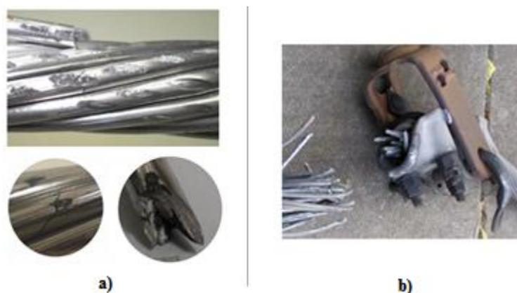
Figura 1.2 – a) Marcas de *fretting* e rupturas nos fios causadas por trincas iniciadas nestas marcas (FADEL, 2010); b) Exemplo de ruptura completa de um cabo causada por fadiga (CLOUTIER & LEBLOND, 2011).
