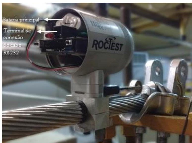
Figura 5.19 – Detalhes construtivos internos do equipamento sem uma das tampas de cobertura.
