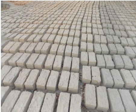
Adobes para construção da casa kalunga
