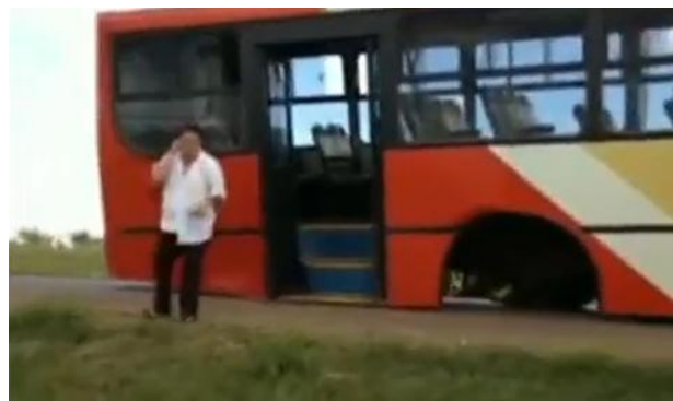
Figura 1.2: Ônibus de Valparaíso no qual perdeu o eixo traseiro em viagem rumo ao Plano Piloto em Julho de 2013 (Correio Braziliense, 2013)
