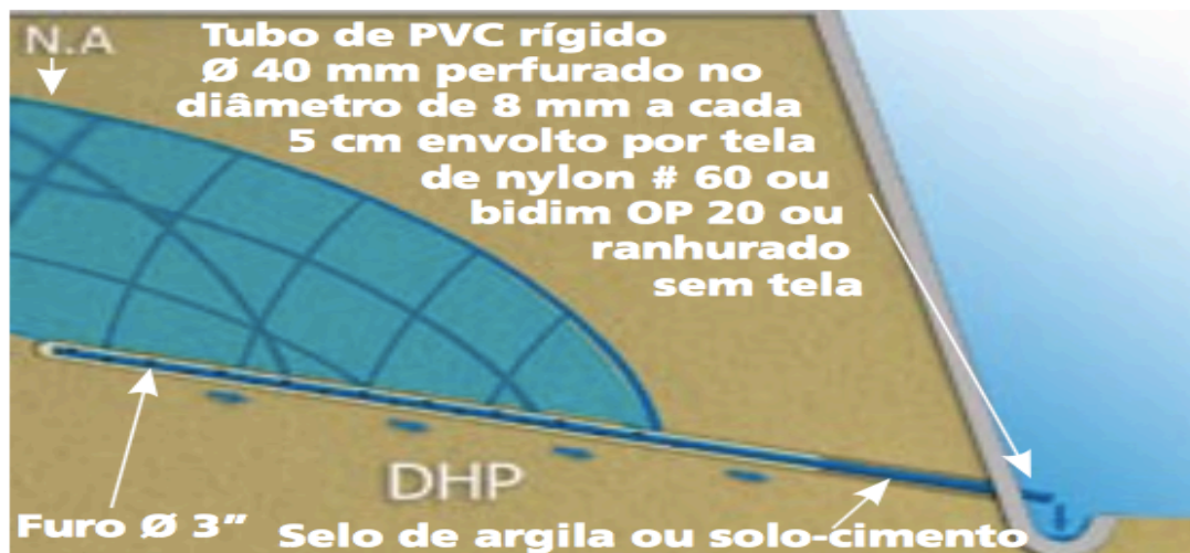
Figura 14 – Exemplo de dreno horizontal profundo (Solotrat, 2015)
