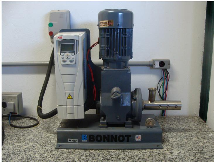
Figura 15. Extrusora para obtenção dos “pellets” do catalisador.
