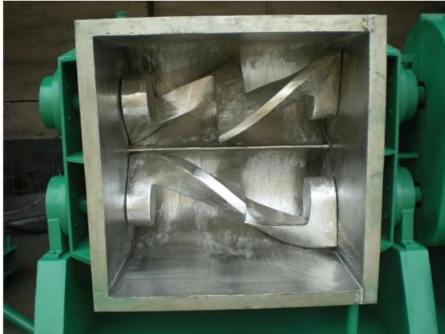
Figura 9. Amassadora de dois braços (lâminas).
