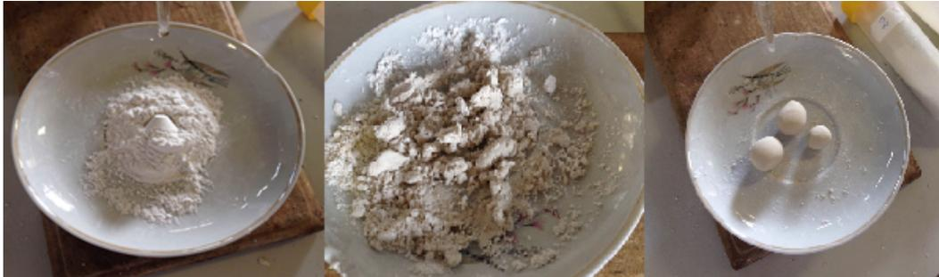
Figura 22. Etapas do teste de absorção na preparação da pasta com diferentes teores de água e amido: (a) início da adição de água; (b) ponto intermediário e (c) ponto final com pasta de boa consistência
