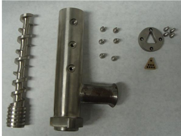
Figura 16. Rosca, cilindro, cabeçote e molde de extrusão.
