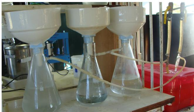
Figura 11. Sistema de filtração usado para lavagem dos sólidos do precursor catalítico.
