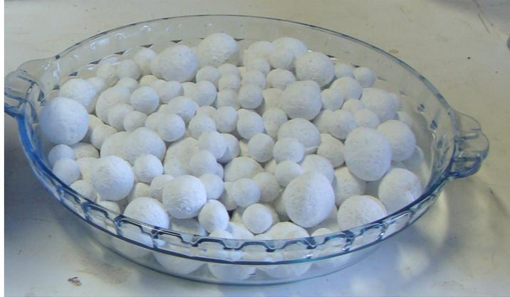
Figura 13. Esferas de cerâmica utilizadas na trituração dos sólidos.
