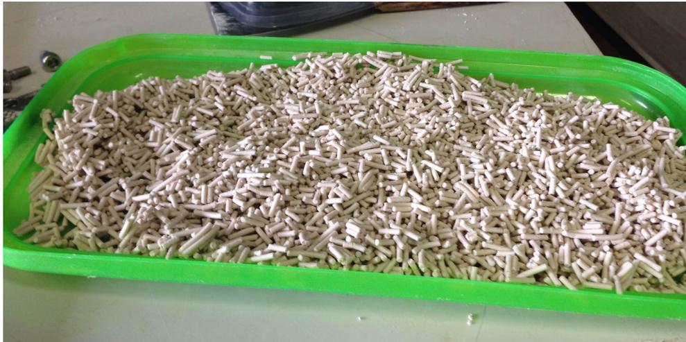
Figura 24. "Pellets" úmidos obtidos após a extrusão.
