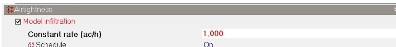
**FIGURA 4.2.3.5 – Renovação do ar dos ambientes internos (Fonte: Design Builder)**
