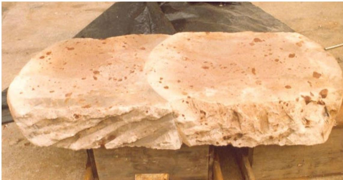
Figura 2.13: Adesão entre colunas de jet grouting (Novatecna, 2003).
