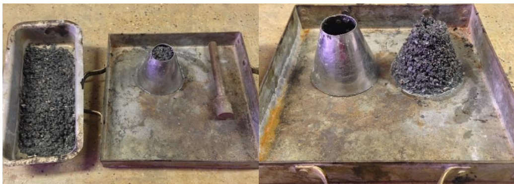
Figura 3.3- Ensaio para determinação da condição saturada com superfície seca dos agregados miúdos
