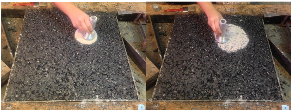
Figura 3.12 - Ensaio de Mancha de Areia em andamento
