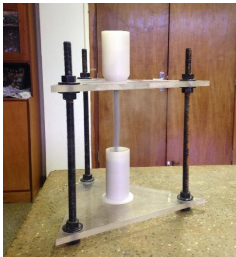
Figura 3.4- Ensaio de angularidade do agregado miúdo
