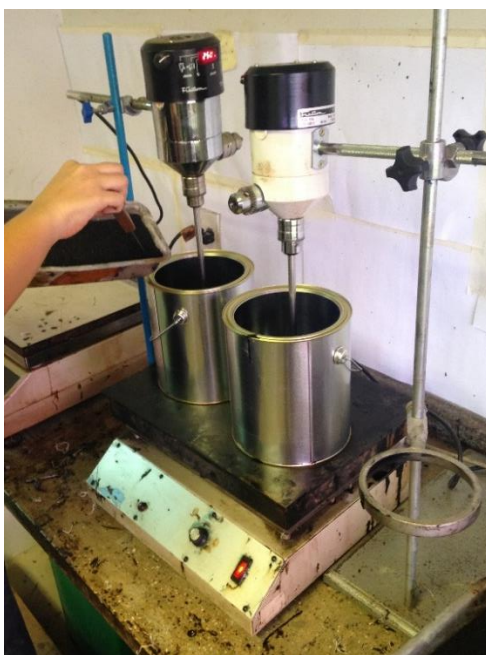
Figura 3.6- Equipamentos utilizados na produção do asfalto-borracha
