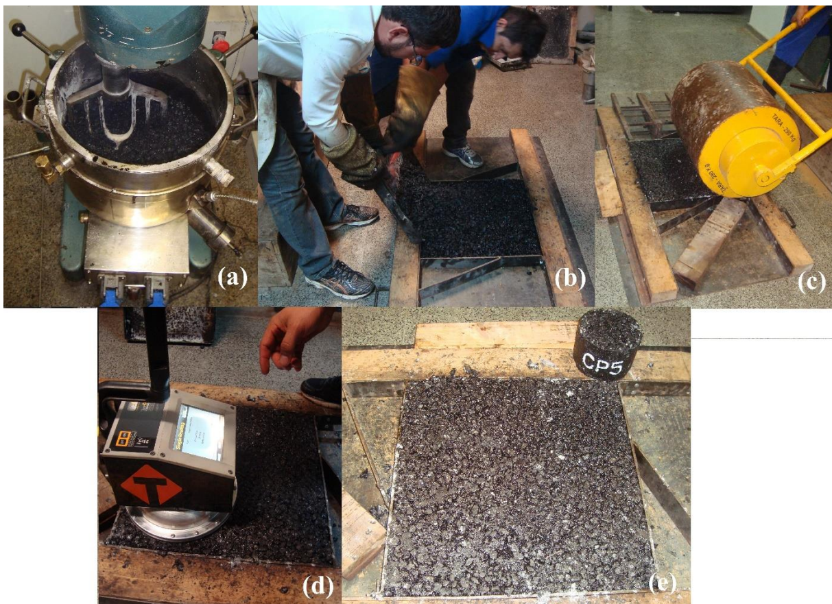
Figura 3.11 - Confecção da Placa Asfáltica: (a) elaboração da mistura asfáltica (agregados e ligante asfáltico); (b) colocação da mistura na forma metálica após 2h; (c) compactação com o rolo monocilíndrico; (d) controle da compactação; (e) textura final
