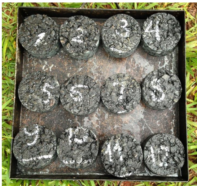
Figura 4.6 - Corpos-de-prova extraídos da placa asfáltica
