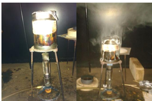
Figura 4.1. Sistema artesanal de carbonização incompleta, a esquerda antes da carbonização e a direita durante o processo de carbonização.
