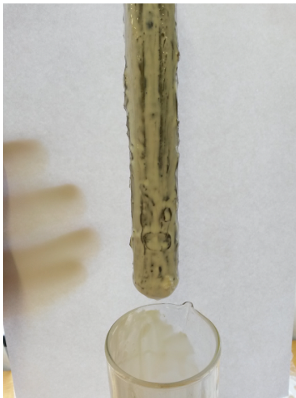
Figura 15 – Aparência após o último banho de látex onde se vê a completa cobertura do material sobre o molde e os sensores.
