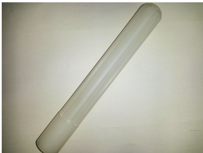
Figura 33 – Molde de náilon usado para testes no início da pesquisa.
