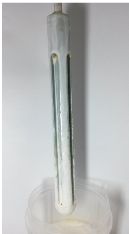
Figura 11 – Molde suspenso após banho de látex para retirada do excesso e iniciar a secagem em ambiente escuro sob temperatura ambiente em torno de 28 °C.
