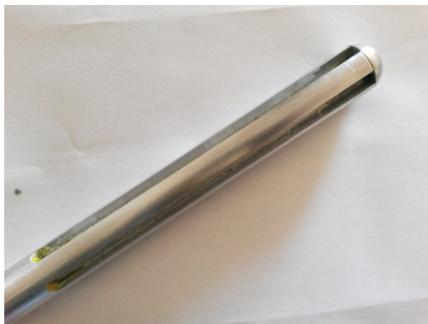
Figura 10 – Molde em alumínio para a confecção do cateter onde pode-se ver os chanfros para a colocação dos sensores.
